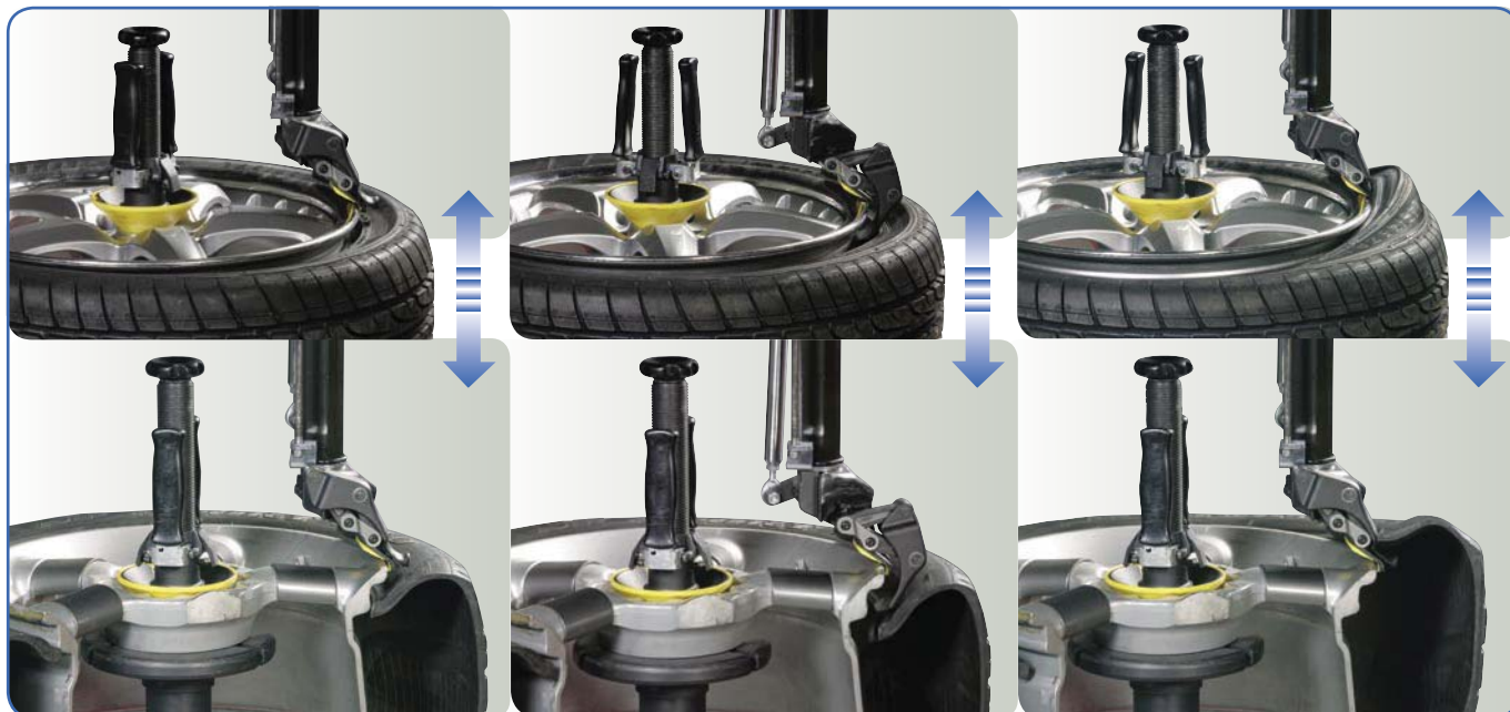
➤ Demontáž horní strany pneumatiky.
