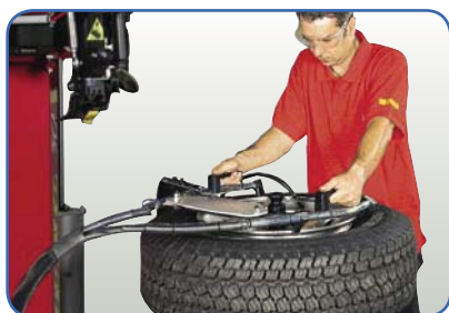
» Systém pro rázové huštění bezdušových pneumatik (tlakové dělo)
